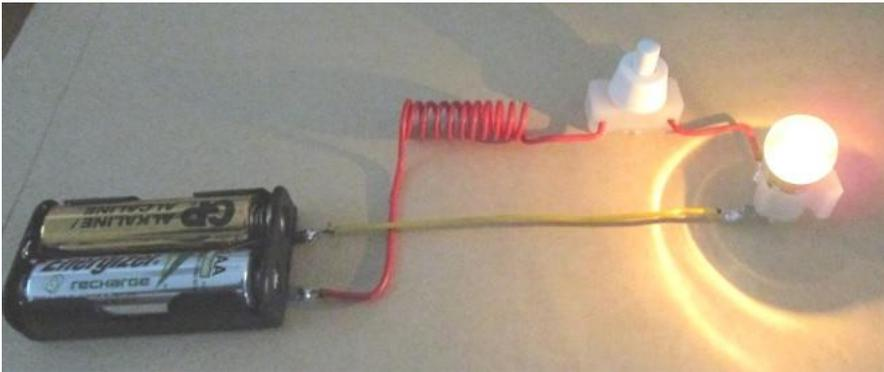
Nur in einem geschlossenen Stromkreis fließt Strom. Bei geöffnetem Schalter stoppt der Stromfluss sofort.
